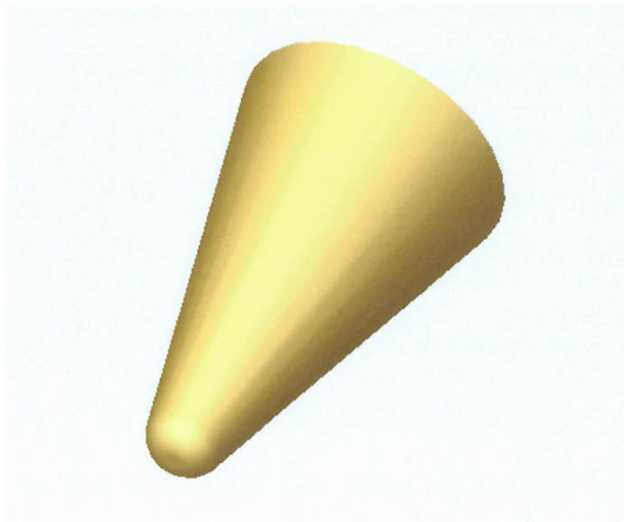
Figura 11.3: Ponta aplicável às extremidades das peças do implante.
