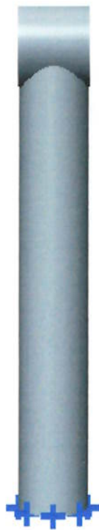
Figura 14.2: Parte do implante aplicável ao fêmur com os engastamentos para a simulação – vista lateral.
