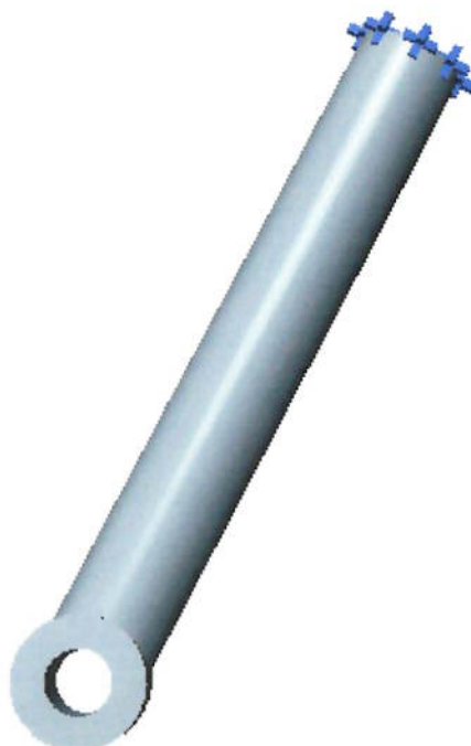
Figura 14.1: Parte do implante aplicável ao fêmur com os engastamentos para a simulação – perspectiva isométrica.
